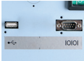
Ports de communication RS 232 et USB host
