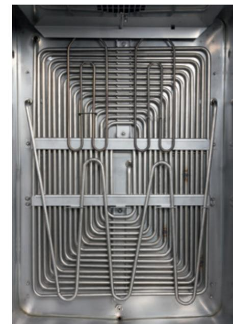
la temperatura prácticamente constante. La humedad condensa en el elemento de congelar y el agua condensada es llevada atrás al recipiente de desagüe de donde es llevada por la bomba hacia desagüe. Gracias a este sistema eficiente, CLIMACELL® EVO alcanza muy rápido incluso los valores de humedad relativa más bajos.
