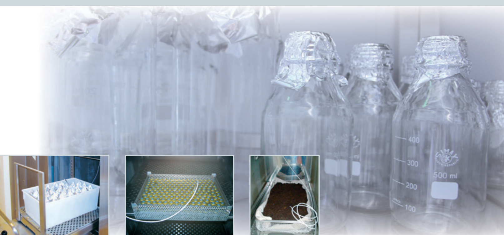
Bedampfung 100° C/10 min – Programmtyp Arnold
